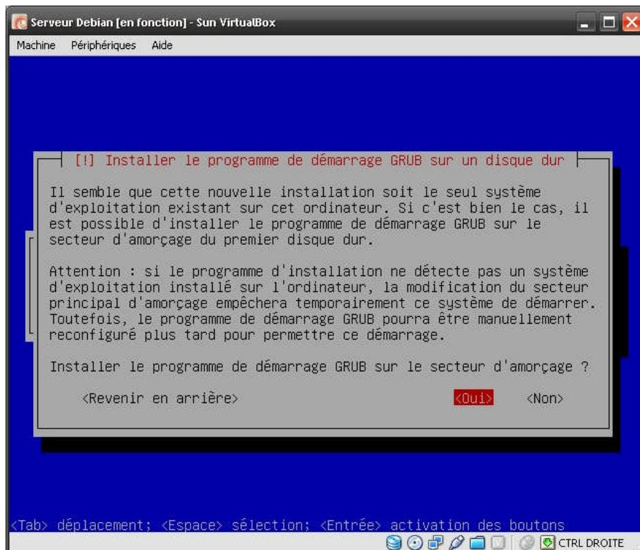
L'installation du GRUB est importante pour l'amorçage de Debian sur le disque dur, sélectionnez Oui
