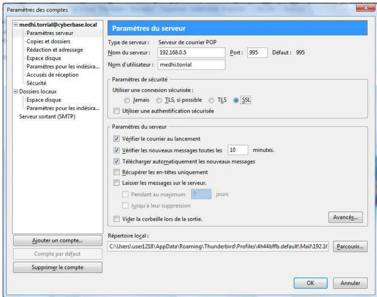
Allez ensuite dans Outils > Paramètres des comptes > Paramètres serveur et en Paramètres de sécurité sélectionnez SSL au lieu de « TLS si possible », car un serveur Postfix est sécurisé en SSL.
